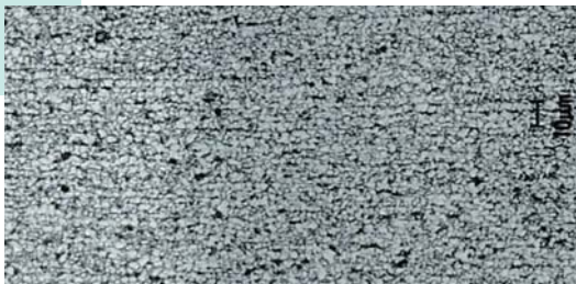
NFG&lt;フェライト粒径2~5μm&gt;
