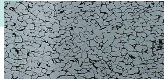
従来の熱延鋼板&lt;フェライト粒径10~15μm&gt;
