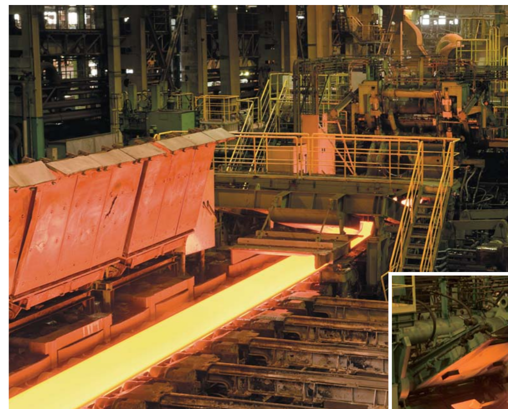
熱延工場 仕上圧延機(入側)
