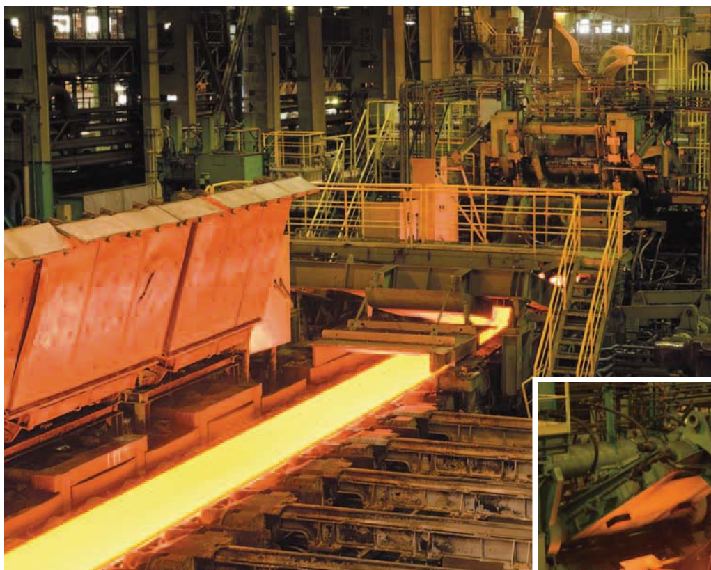
熱延工場 仕上圧延機(入側)
