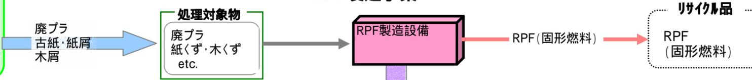
RPF(廃プラスチック・紙くず等を原料とする固形燃料)製造設備の処理フロー
